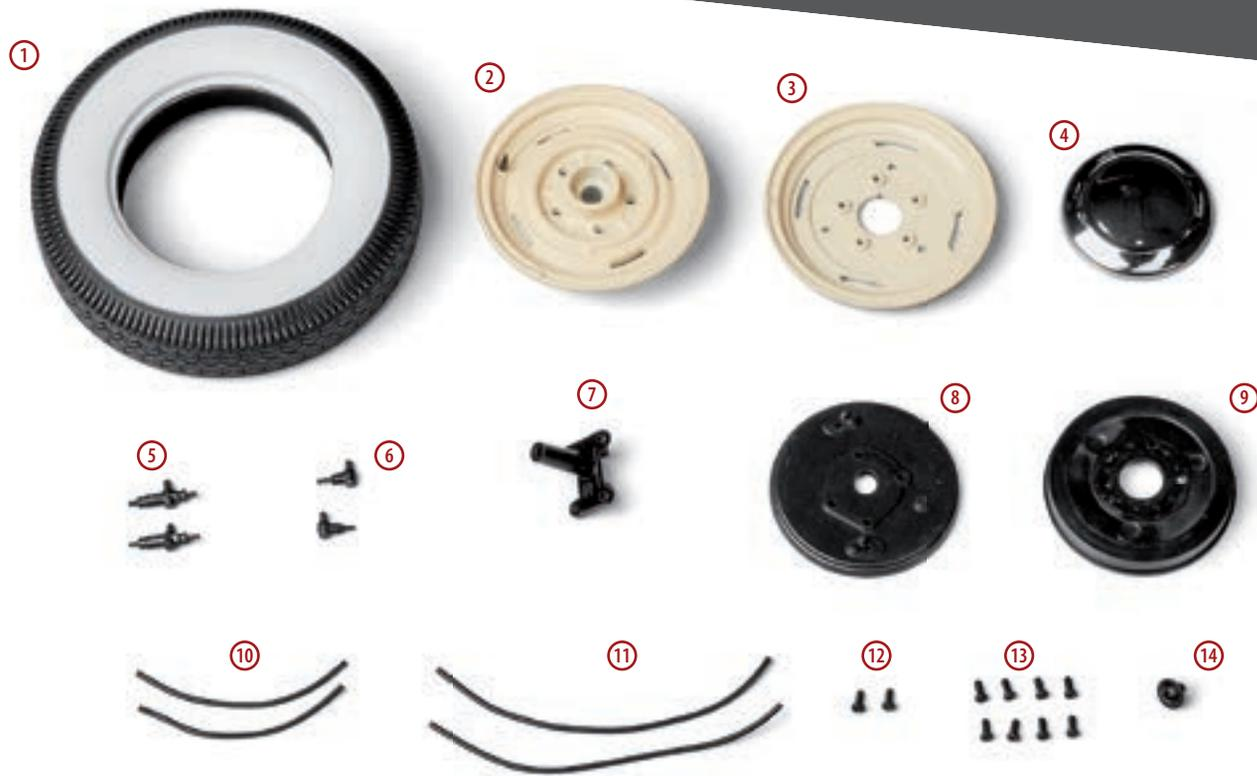
1 — покрышка; 2 — диск колесный (внешняя часть); 3 — диск колесный (внутренняя часть); 4 — колпак колеса; 5 — штуцер тормозной верхний — 2 шт.; 6 — штуцер тормозной нижний — 2 шт.; 7 — кулак поворотный; 8 — щит переднего тормоза; 9 — тормозной барабан; 10 — трубка тормозная промежуточная — 2 шт.; 11 — трубка тормозная переднего колеса — 2 шт.; 12 — винт 1,7×4 (AP) — 2 шт.; 13 — винт 1,7×4 (AM) — 8 шт.; 14 — винт 2,3×4 с прессшайбой (DM)
