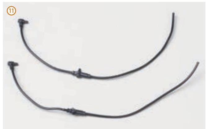
Аналогичным образом соедините детали второй тормозной магистрали переднего колеса: верхний и нижний штуцеры, промежуточную и основную тормозные трубки.
