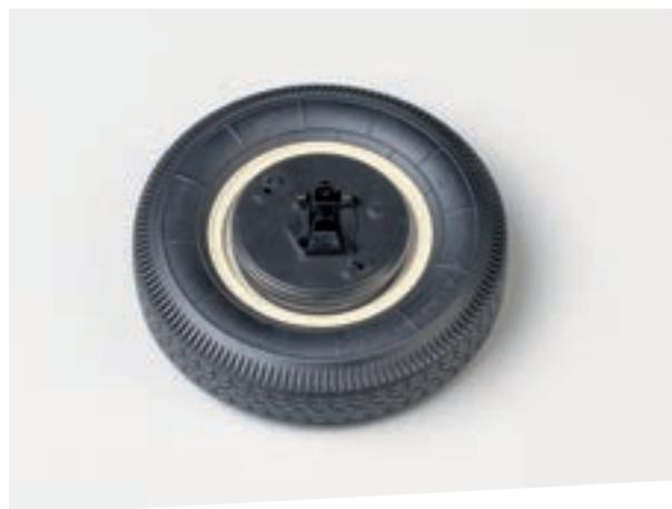
Вставьте собранные ранее тормозной щит и поворотный кулак в центральное отверстие переднего колеса (с внутренней стороны).
