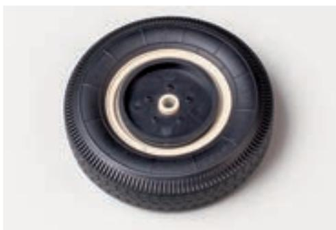
Установите имитацию тормозного барабана поверх внутренней части колесного диска таким образом, чтобы отбортовка барабана оказалась на внешней (верхней на фото) плоскости детали. Закрепите тормозной барабан на диске при помощи пяти винтов 1,7×4 (AM).
