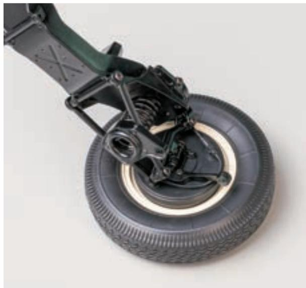
Установите вторую тормозную трубку на собранном ранее левом переднем колесе. Аналогичным образом вставьте нижний тормозной штуцер в нижнее отверстие левого тормозного щита, проложите промежуточную тормозную трубку ниже поворотного кулака и закрепите верхний тормозной штуцер на тормозном щите. При необходимости уменьшите длину промежуточной тормозной трубки.
