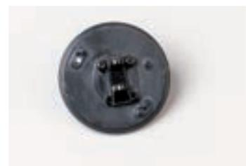
Поместите поворотный кулак на внешней плоскости щита переднего тормоза. Совместите крепежные отверстия деталей и вставьте два винта 1,7×4 (AP) в верхние крепежные отверстия поворотного кулака. Нижние крепежные отверстия должны остаться свободными, в дальнейшем в них будет закреплён кронштейн поворотного кулака.
